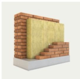
Слоистая кладка представляет собой трехслойную систему теплоизоляции стен. Несущая стена выполняется из кирпича, бетона, керамзитобетона, блоков и других материалов. Далее выполняют крепление слоя минплиты и устанавливается внешняя стена из лицевого кирпича. Наружная стена несет защитно-декоративную функцию. В качестве минваты для стен слоистой кладки рекомендуется использовать экологически
